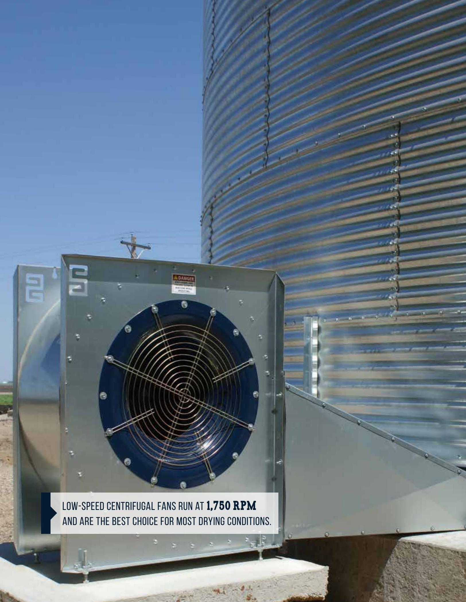
LOW-SPEED CENTRIFUGAL FANS RUN AT **1,750 RPM**
